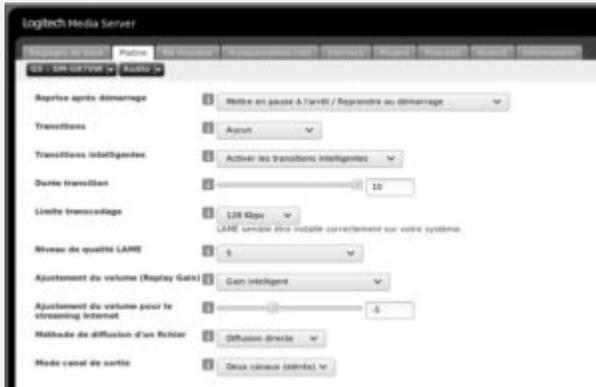
Il est important de limiter le débit de la diffusion (Streaming) à partir du menu de LMS via la page web des paramètres du serveur.
