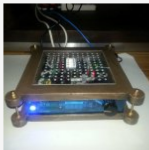
RaspberryPIB+ avec Hifimedi y DDX320v2.3 – 2.1 Digital Amplifier
