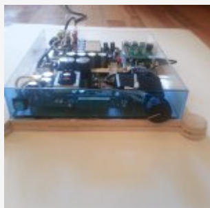
RaspberryPIB+ avec Hifimedi y DDX320v2.3 – 2.1 Digital Amplifier
